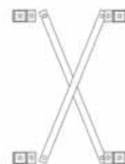
Crociere controventi per scaffali incastro Crosswise light duty braces
