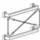
Controventature verticali di schiena Back vertical braces
