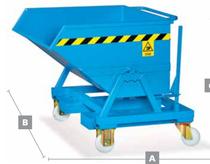
● MG350 Contenitore ribaltabile, con 4 ruote Ø 150 mm. (2 girevoli, 2 fisse). Portata 1000 kg. capacità lt. 430 Tip-up container, with 4 wheels Ø150 mm (2 revolving, 2 fixed). Capacity 1000 kg. Capacity lt. 430 Benne basculante sur roues diam. 150 (2 fixes et 2 pivotantes). Charge kg. 1000 Capacité lt. 430 A 1175 (l.) / B 1060 (p.) / C 1040 (h.)
